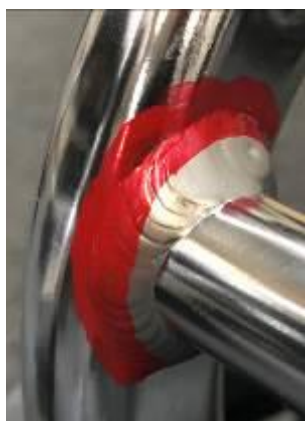
写真1 (使用可能) ヒビはない。全体的に色味には変化がない。
