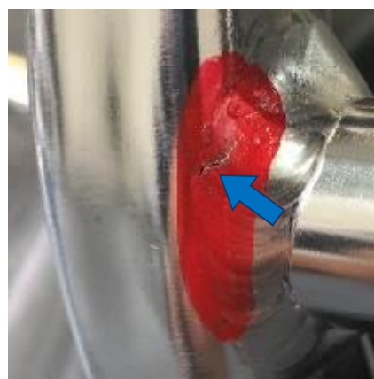
写真3 (要問合せ) 溶接止端に細かいキズがある(青矢印)。
