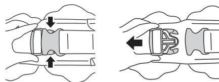
バックルの上下を押さえ、ベルトを引き抜いてください。
