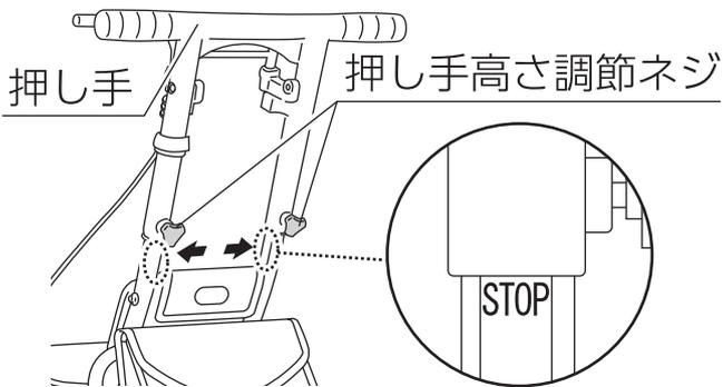
左右の押し手高さ調節ネジをゆるめてください。押し手を上下させ高さを決めたあと、押し手高さ調節ネジを確実に締めてください。左右のハンドルフレーム内側に「STOP」マークが見えたら、押し手が最高位置にあることを示します。
