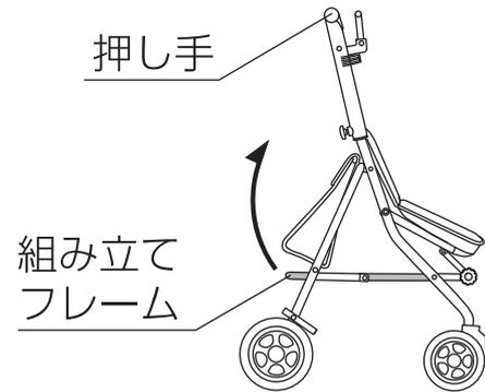
押し手を持ちながら組み立てフレームを矢印の方向にあげてください。
