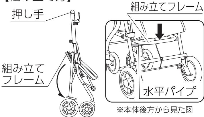
押し手を持ちながら組み立てフレームを矢印の方向にさげてください。(かならず水平パイプに当たるまでおろしきってください。)
