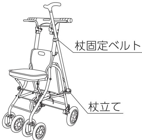
押し手に付いている杖固定ベルトで杖を固定し、杖立てで受けてください。
