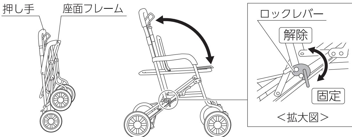
**【組み立て方】** 押し手と座面フレームを持ち、矢印の方向に広げてください。
