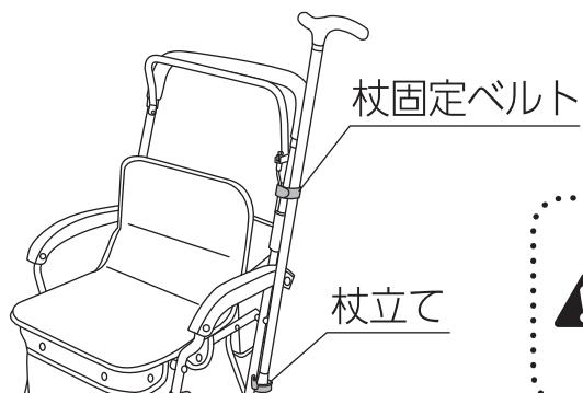
押し手に付いている杖固定ベルトで杖を固定し、杖立てで受けてください。
