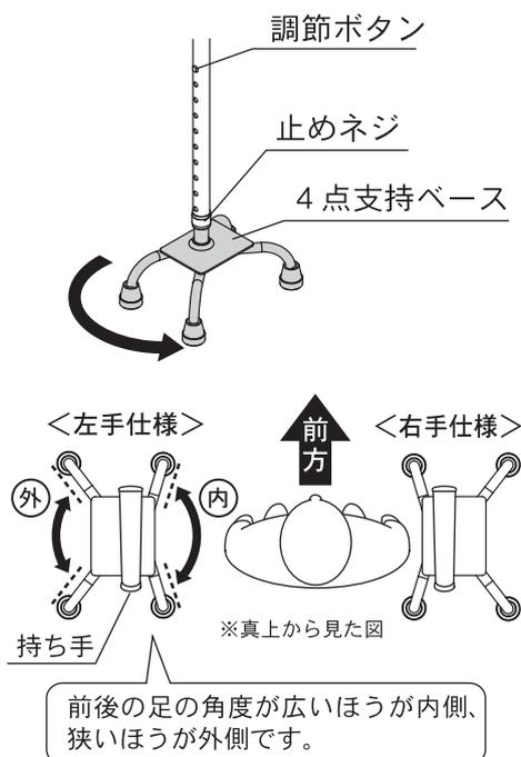
止めネジをゆるめ、調節ボタンを指で押さえながら、4点支持ベースを180度回転させてください。調節ボタンが調節穴から出たことを確認し、止めネジを確実に締めてください。
