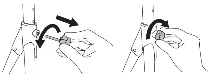
ノブボルトを反時計回りに回して取りはずしてください。
