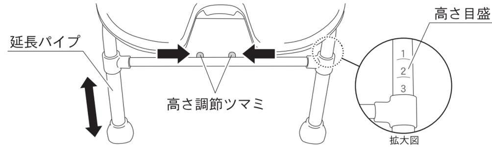
座面高さは5段階に調節することができます。高さ調節ツマミを内側に寄せながら延長パイプを上下させ、調節したい高さ目盛に合わせたあと、指をはなしてください。高さ調節ツマミが外側に開いて延長パイプが固定されたことを確認してください。
