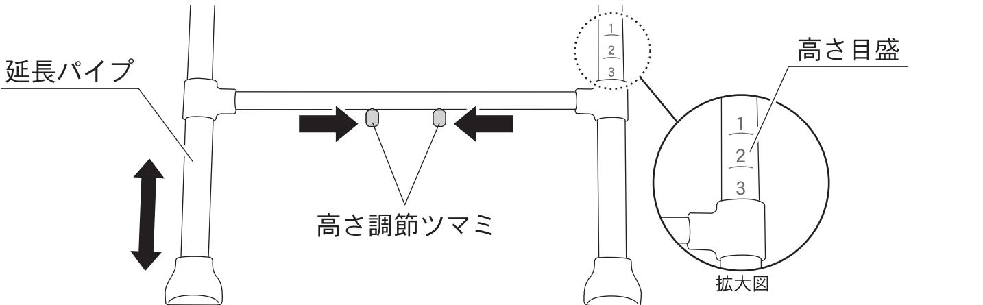
座面高さは5段階に調節することができます。高さ調節ツマミを内側に寄せながら延長パイプを上下させ、調節したい高さ目盛に合わせたあと、指をはなしてください。高さ調節ツマミが外側に開いて延長パイプが固定されたことを確認してください。
