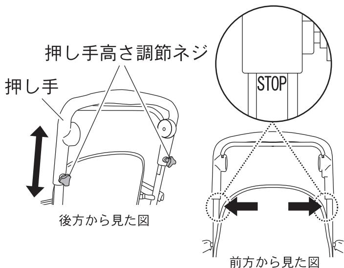
左右の押し手高さ調節ネジをゆるめてください。押し手を上下させ高さを決めたあと、押し手高さ調節ネジを確実に締めてください。
