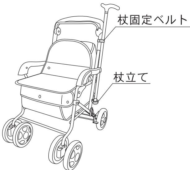
押し手に付いている杖固定ベルトで杖を固定し、杖立てで受けてください。
