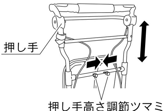
押し手高さ調節ツマミを内側に寄せて固定を解除してください。そのまま押し手を上下させ、お好みの高さでツマミをはなしてください。ツマミが外側に開いて、押し手が固定されたことを確認してください。
