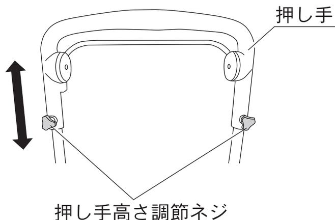
左右の押し手高さ調節ネジをゆるめてください。お好みの高さのネジ穴に合わせ、押し手高さ調節ネジを確実に締めてください。
