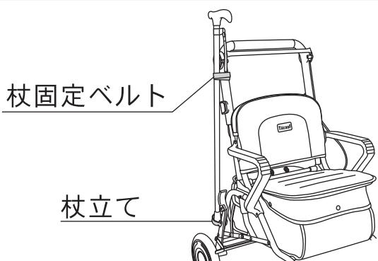
押し手に付いている杖固定ベルトで杖を固定し、杖立てで受けてください。
