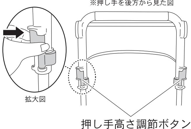
左右の押し手高さ調節ボタンを押したまま、押し手を上下させ、お好みの高さでボタンをはなしてください。その後、押し手が固定されたことを確認してください。
