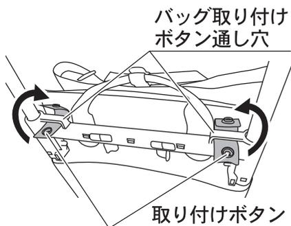
バッグ背面にある左右の取り付けボタンの凹をバッグ取り付けボタン通し穴に通し、ボタンをはめてください。
