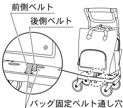
バッグ下部にある前側ベルトと後側ベルトをバッグ固定ベルト通し穴にさし込んでください。
