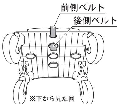
荷台フレーム裏側にあるバッグの前側ベルトと後側ベルトの面ファスナーをゆるみがないように取り付けてください。
