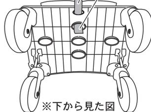
荷台フレーム裏側にあるバッグの前側ベルトと後側ベルトの面ファスナーをゆるみがないように取り付けてください。
