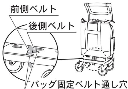
バッグ下部にある前側ベルトと後側ベルトをバッグ固定ベルト通し穴にさし込んでください。
