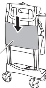
バッグ後方のフレーム取り付けカバーにハンドルを通してください。
