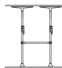
6 手すりが水平になるように、しっかりと固定ネジを締めて固定してください。
