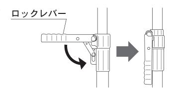
上パイプの赤ラインがかくれていることを確認してください。※赤ラインが見えている場合は、突っ張り強度が不足しています。再設置してください。
