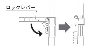
5 ロックレバーにロック ネジを取り付け、時計 回りの方向へ回して、 ロックレバーを固定し ます。
